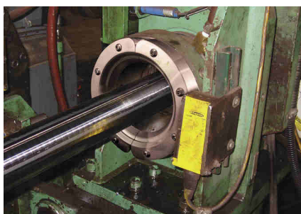
Super Air Wipe 2404 pulisce un cilindro d'acciaio durante la lavorazione
