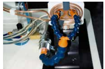
Raffreddamento trafilatura per produrre tubetti uso medico
