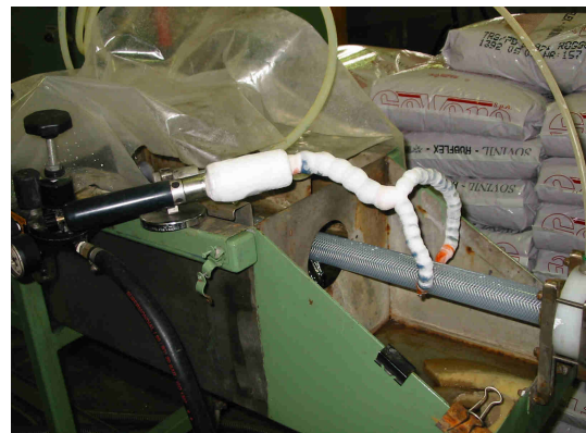
Raffreddamento di tubi dopo l'estrusione
