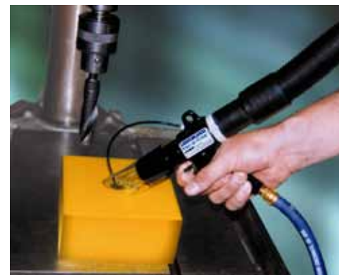
Deep Hole Vac-U-Gun 6094 soffia nel foro e aspira i residui di lavorazione
