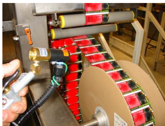
Ion Air Gun 7193 neutralizza cariche su etichette in film termoretraibile
