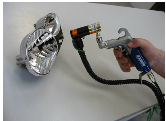
Gen4 Deluxe Ion Air Gun neutralizza la carica da fanali di motociclette prima dell'assemblaggio per evitare attrazione di polvere
