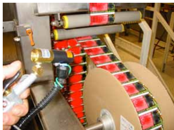
Ion Air Gun 7193 neutralizza cariche su etichette in film termoretraibile
