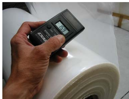
Rilevazione di cariche elettrostatiche su film termoretraibile
