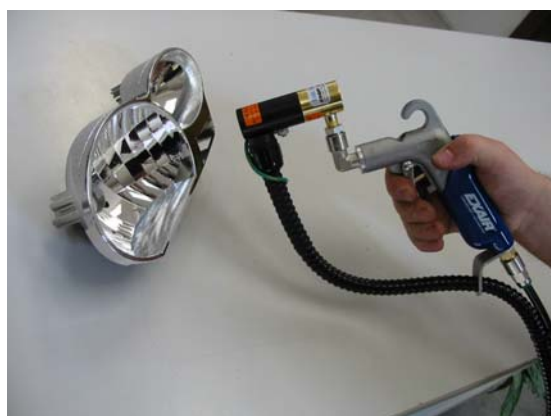
Deluxe Ion Air Gun neutralizza la carica da fanali di motociclette prima dell'assemblaggio per evitare attrazione di polvere
