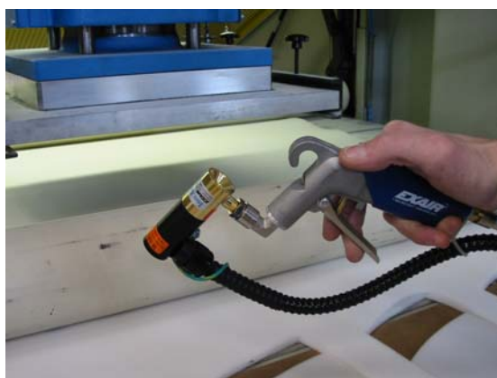
Deluxe Ion Air Gun 7193DLX neutralizza cariche elettrostatiche su gommapiuma
