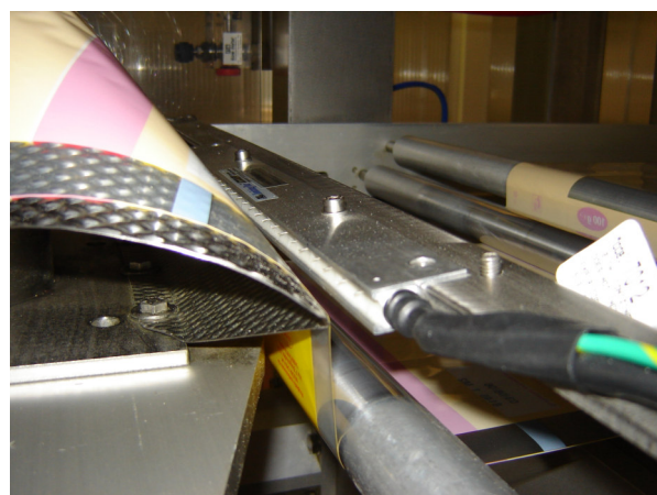
Barra Ionizzatrice Gen4 8012 elimina cariche elettrostatiche da film per imballaggio
