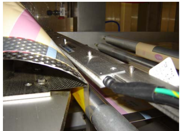
Barra Ionizzatrice 7012 elimina cariche elettrostatiche da film per imballaggio
