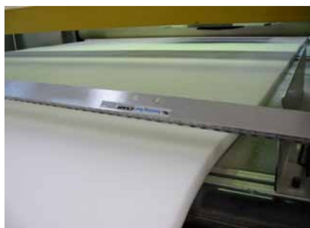
Barra Ionizzatrice 7036 elimina cariche da poliuretano espanso flessibile
