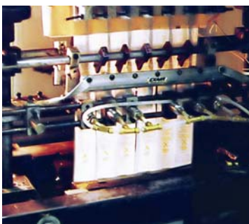
Standard air Knife apre sacchetti per confezionamento
