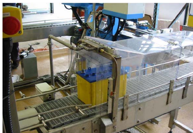
Asciugatura di batterie per autotrazione dopo riempimento con acido
