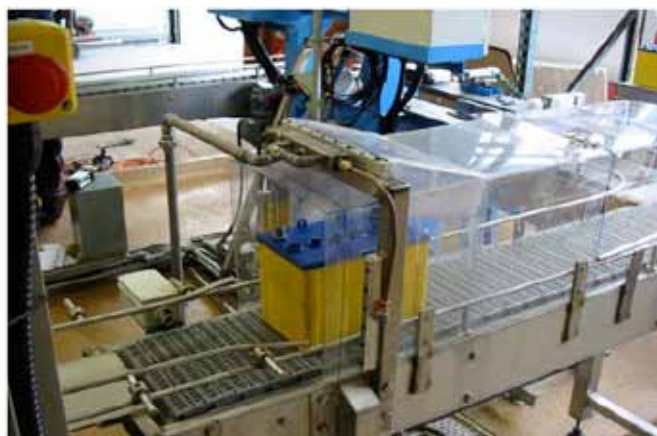
Asciugatura di batterie per autotrazione dopo riempimento con acido
