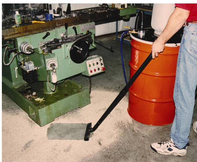
Chip Vac aspira residui di lavorazione
