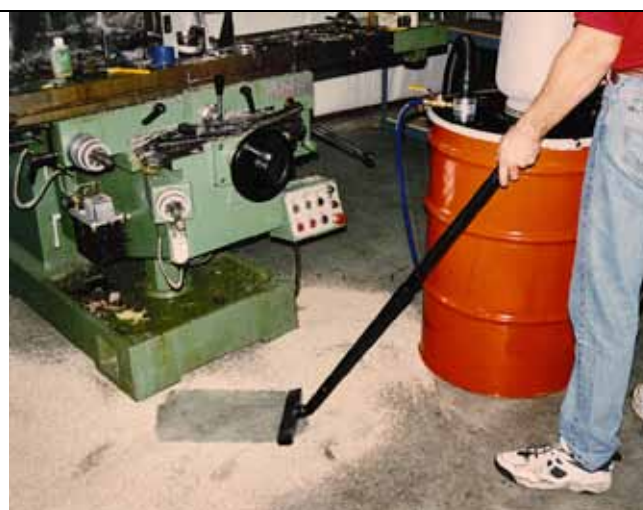
Chip Vac aspira residui di lavorazione
