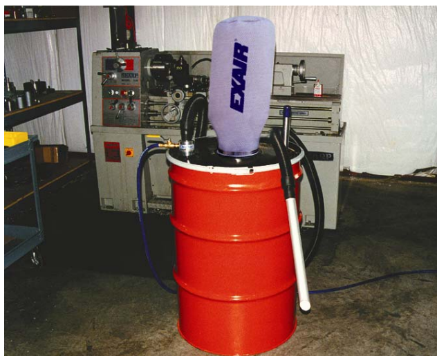
Chip Vac System installato su fusto da 200 litri
