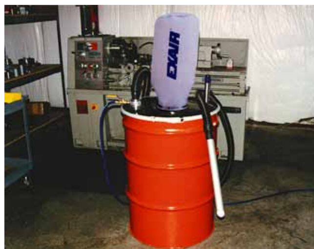
Chip Vac System installato su fusto da 200 litri
