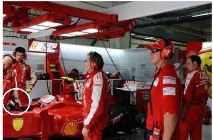
Amplificatore Exair cod 6042 che soffia aria sul pilota durante una pausa ai box
