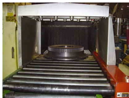
Alcuni amplificatori codice 6041 puliscono e raffreddano pezzi in ghisa dopo la lavorazione
