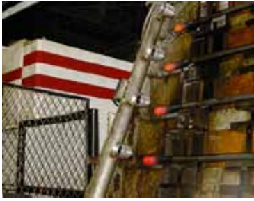
Amplificatori cod 6042 raffreddano barre dopo il riscaldamento ad induzione
