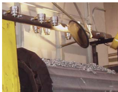
Amplificatori codice 6042 asciugano pezzi dopo il lavaggio
