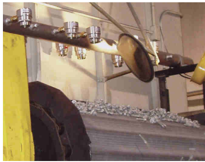
Amplificatori cod 6042 asciugano pezzi dopo il lavaggio
