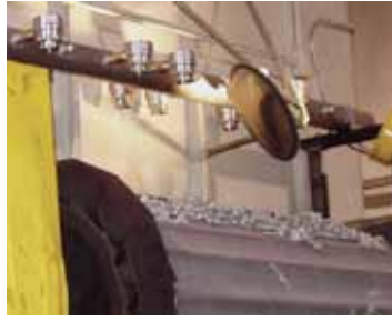
Amplificatori cod 6042 asciugano pezzi dopo il lavaggio
