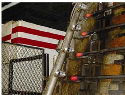
Amplificatori codice 6042 raffreddano barre dopo il riscaldamento ad induzione
