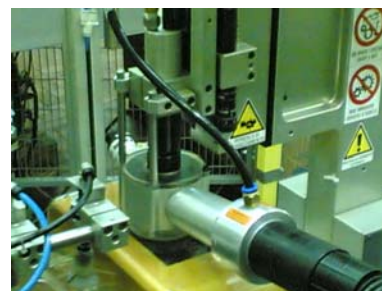
Aspirazione trucioli di plastica durante l'asportazione di bave
