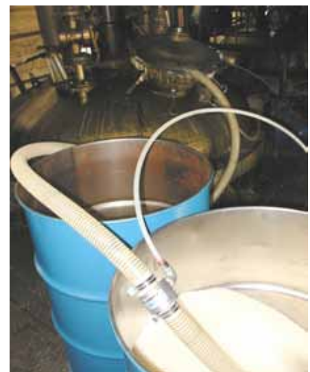
Line Vac 6082 convoglia granuli di colla nella caldaia di fusione
