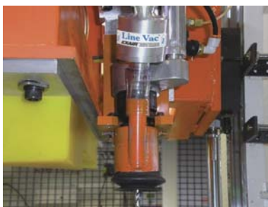
Aspirazione di trucioli durante le operazioni di foratura
