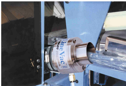
Line Vac codice 6084 aspira sfridi di lavorazione in figura film plastico
