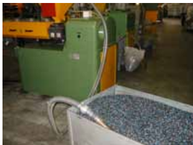
Line Vac codice 6082 trasporta oltre 10 Kg/min di granuli
