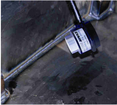
Raffreddamento di cordoni di saldatura
