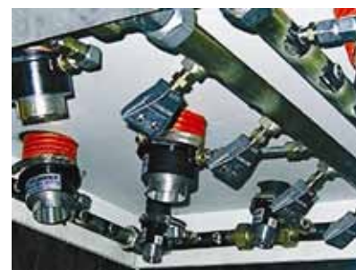
Sistema composto da amplificatori ed ugelli piatti Exair
