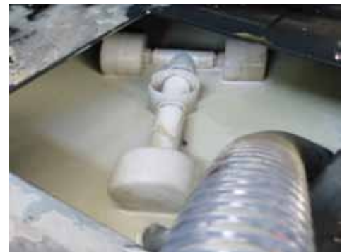
Vasca emulsione dopo la depurazione Coolant sump after separation process
