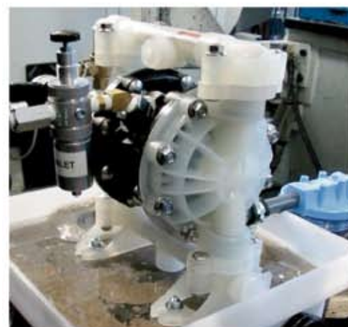
Pompa a doppio effetto autoadescante a funzionamento pneumatico
