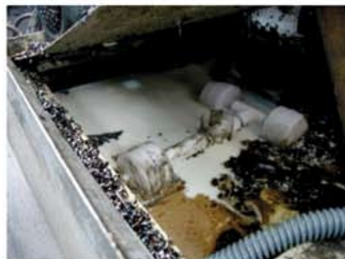
Vasca con presenza di olio e morchia galleggiante
