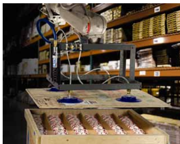
Sollevatore dotato di generatore E-Vac e quattro ventose Exair
