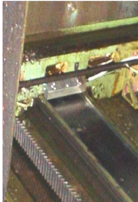
Super Air Knife che mantiene pulita la guida della macchina utensile
